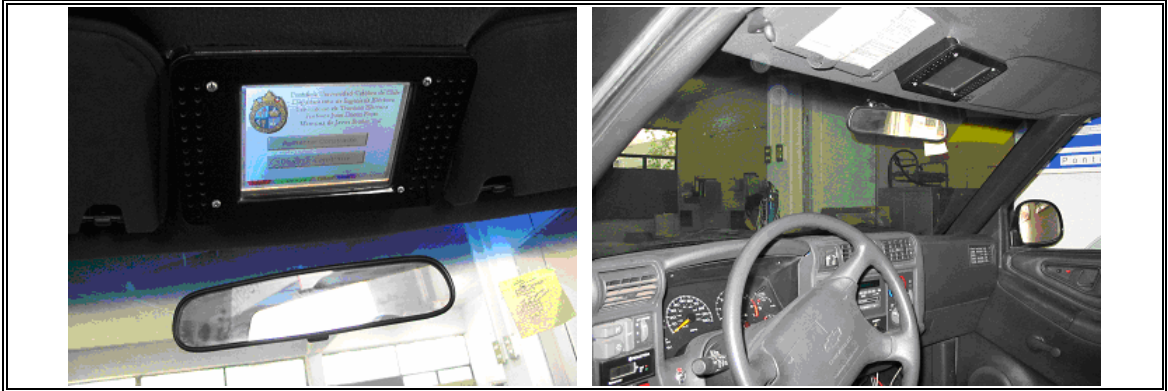
Figura 6.10: Fotografías de la instalación de la pantalla en la cabina.
